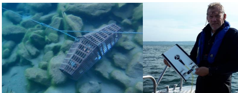
Figur 12. T.v. Bild tagen med undervattensdrönare. Vätterns klara vatten skapar goda förutsättningar för att detektera redskap. Möjligheterna är flera då både drönare under som över vattnet nu finns att tillgå (Foto: Michael Bergström, Daniel Rydberg).
